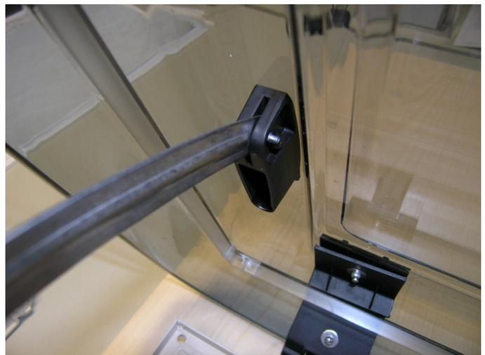
b. Schließen Sie die Haube soweit, dass die Verriegelungshaken nicht in den Verschluss eingreifen. Achten Sie hierbei darauf, dass die Aufsteller lose in den Haubenflansch steckt, damit gewährleistet ist dass die Haube richtig schließt.
